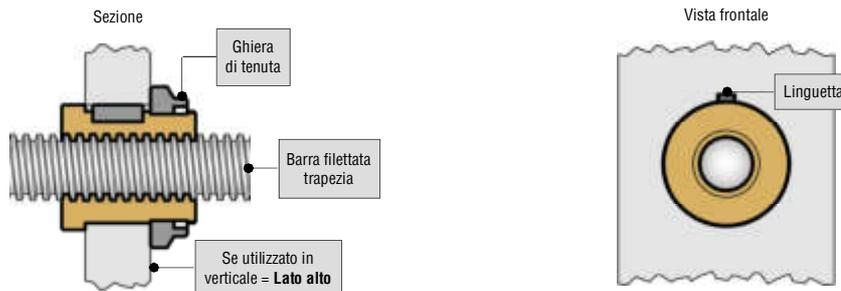
**Per la lubrificazione suggeriamo un foro trasversale al supporto/chiocciola filettato alle estremità per l'inserimento di un ingrassatore o di un raccordo.**
