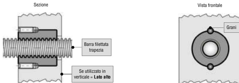
Per l'utilizzo delle chioccioline cilindriche dovete realizzare una sede nel vostro supporto in tolleranza **K6 (oppure H7)** calettare la chiocciola fissandola con i grani come da disegno. Per la scelta del diametro del grano da utilizzare consigliamo il seguente calcolo con approssimazione +/- 10% ed esattamente:
