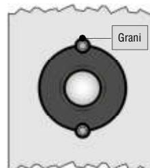
Per l'utilizzo delle chioccioline cilindriche dovete realizzare una sede nel vostro supporto in tolleranza **K6 (oppure H7)** calettare la chiocciola fissandola con i grani come da disegno. Per la scelta del diametro del grano da utilizzare consigliamo il seguente calcolo con approssimazione +/- 10% ed esattamente:
