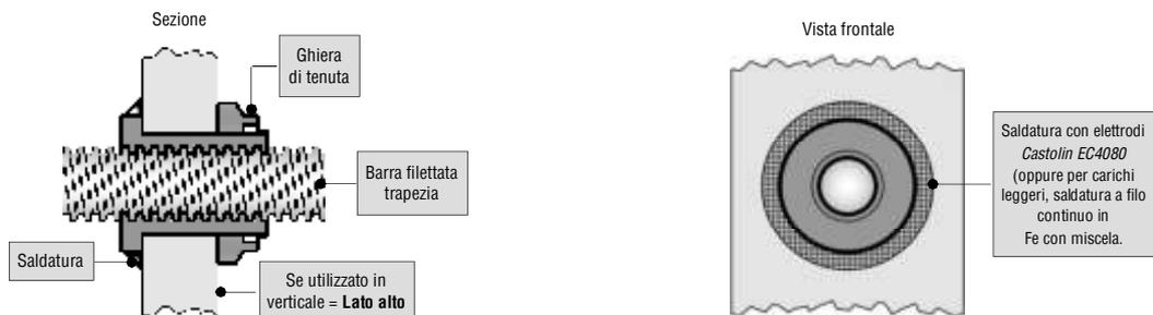
**Per la lubrificazione suggeriamo un foro trasversale al supporto/chiocciola filettato alle estremità per l'inserimento di un ingrassatore o di un raccordo.**
